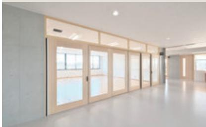
建物付帯工事として溶接により躯体に取付ける間仕切ならびに壁面化粧鋼板パネルの金属工事です。
